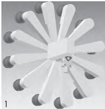
Vom ersten CAD Modell einer Polyamid Roboterhand...
