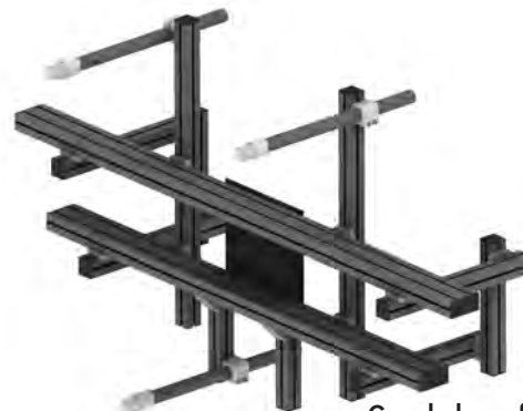
Grundrahmen für Stoßfängergreifer „Matrizenentnahme“
