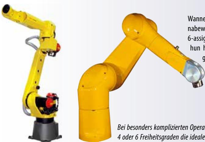
Wanneer bijzonder ingewikkelde handelingen - zoals nabewerkingsactiviteiten op het gegoten voorwerp vereist zijn-, zijn 6-assige robots met 4 of 6 vrijheidsgraden de ideale oplossing. Dankzij hun hoge flexibiliteit kunnen deze robots mankracht in zware- of gevaarlijke situaties vervangen. Star Automation Europe kan 6-assige robots integreren welke zijn geleverd door de belangrijkste fabrikanten zoals FANUC of Stäubli. Star kan deze robots installeren en het personeel opleiden en trainen.
