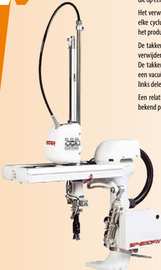
De pneumatische takkenpikker van de Sp-F IV-serie is tegenwoordig de eenvoudigste automatisering die op een sputgietmachine kan worden geplaatst.
